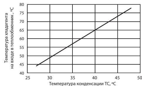
Рис. 2. Температура хладагента на входе в теплообменник
