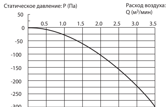
Расход приточного воздуха (подача воздуха в блок)
